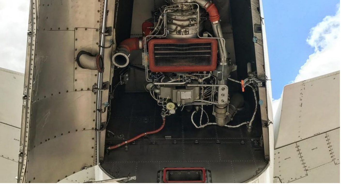
Şekil 4. Bir sivil/ticari uçak APU'su (uçanın egzoz konisine yerleştirilmiş) Kaynak: Aeroclass.org ( https://www.aeroclass.org/auxiliary-power-unit/ )
