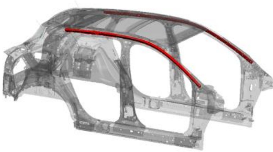
Şekil - 6 AHSS Malzemelerin Ana Gövde Üzerinde Kullanımı [12]
