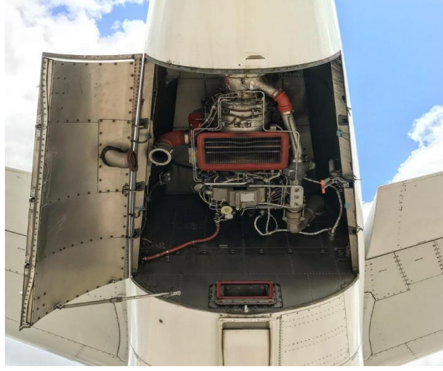
Şekil 4. Bir sivil/ticari uçak APU'su (uçanın egzoz konisine yerleştirilmiş)
