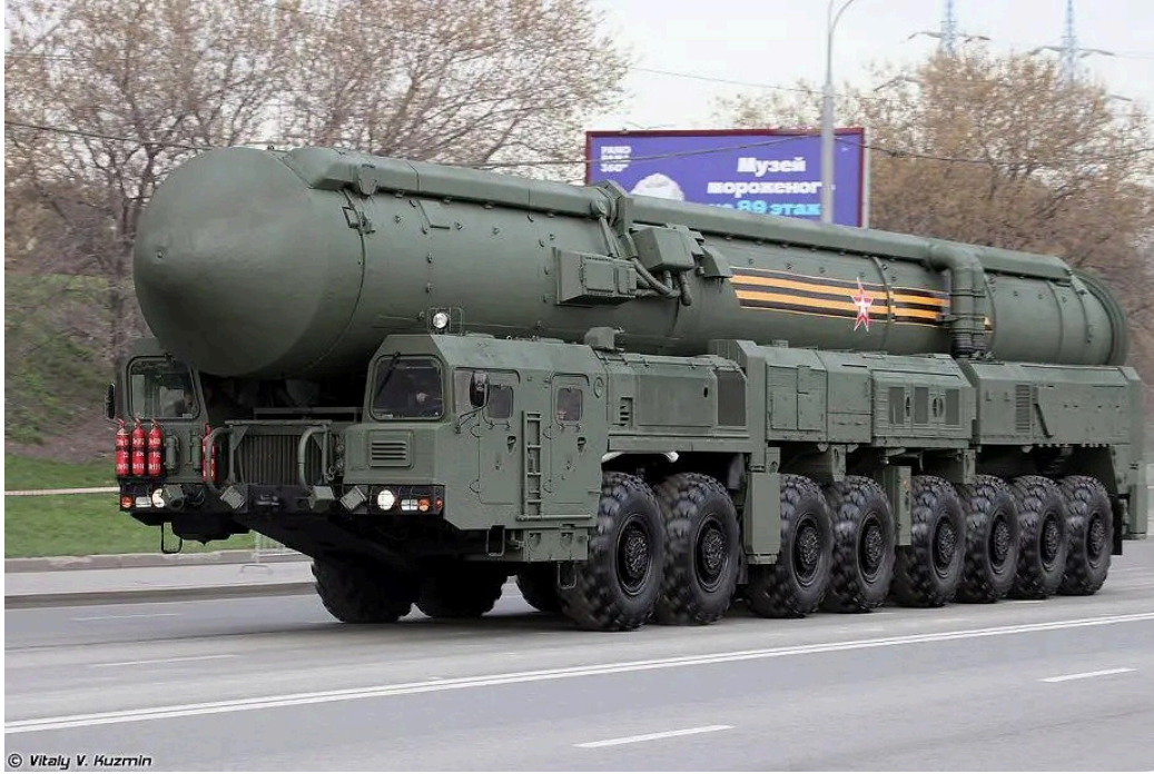
Şekil 1. Çok akslı TTA tabanlı TEL örneği (16x16 sınıfı): RS-24 Yars (MZKT-79221).
